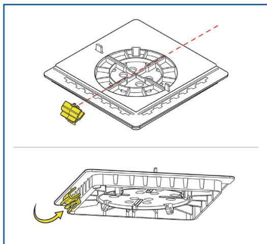
› Avant de positionner les plaques à dalle sur chaque plot en périphérie, placer 1 clip de fixation dans un piège à colle de la plaque à dalle (cf. schéma ci-contre).
